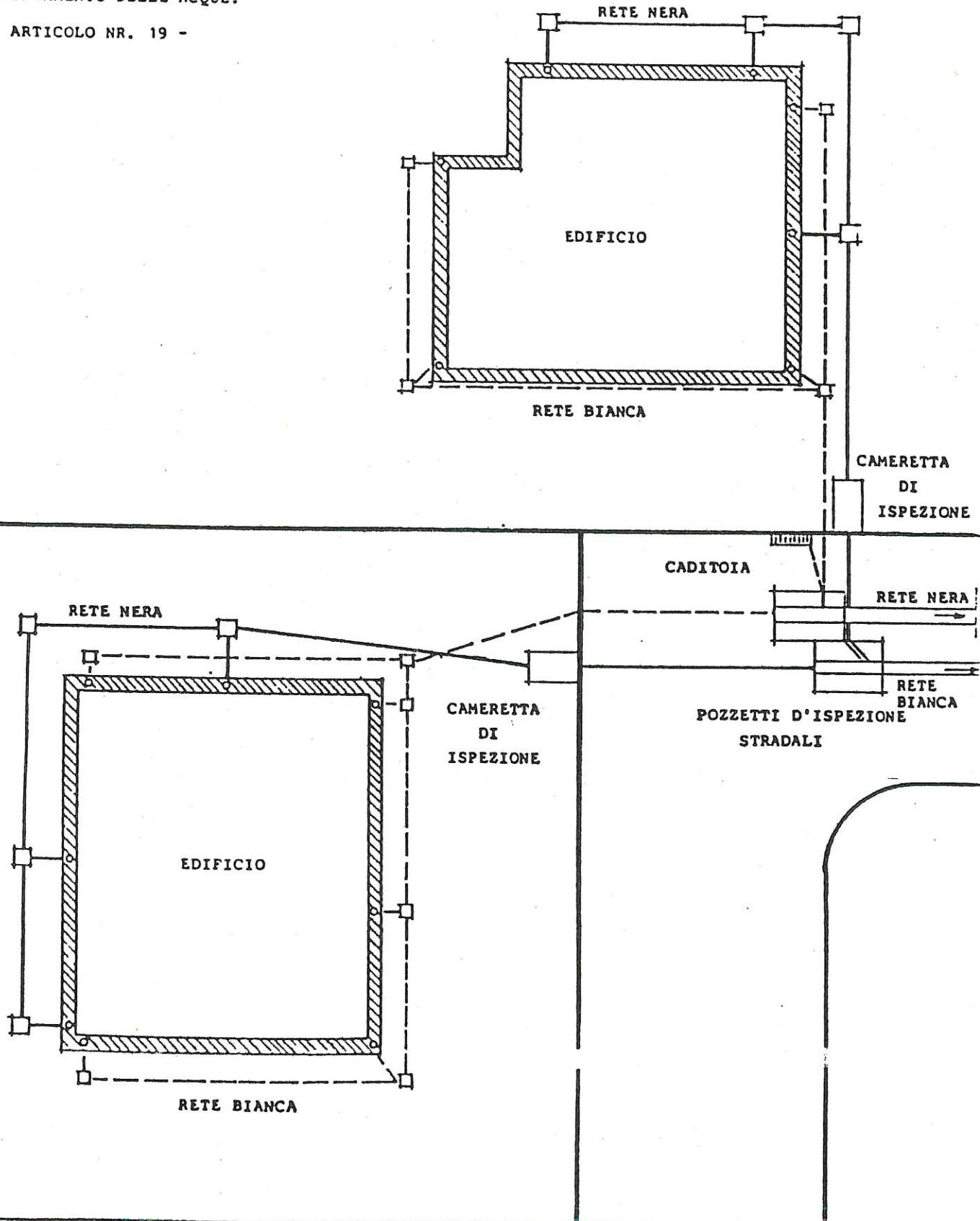
ALLEGATO "F" - SCHEMA DI ALLACCIO DELLE CANALIZZAZIONI PER ACQUE NERE ALLA FOGNATURA PUBBLICA A SEGUITO DELL'ENTRATA IN VIGORE DELLE NORME DI ATTUAZIONE DEL PIANO PROVINCIALE DI RISANAMENTO DELLE ACQUE.
